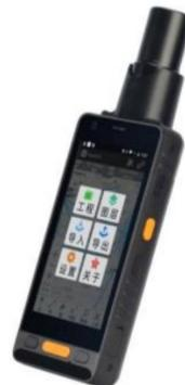
Fig.9-1-2 Unidad portátil RTK externa
